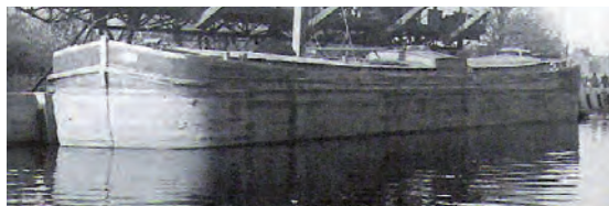
Le Wallon , bateau typique des canaux avec ses bordés droits, sa cabine centrale et ses « moustaches ». Collection Cercle d'histoire de Saint-Ghislain.
